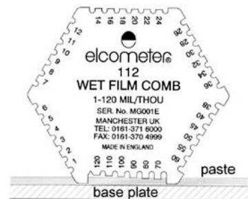
Рисунок 22. Гребёнка для измерения толщины слоя термопасты
